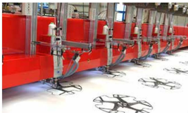
Technický systém ZSK CZCW 0809 - s osmi W-hlavicemi pokládání a fixace vláken.
