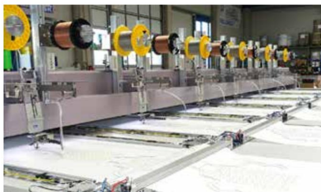
Technický systém ZSK CYCW 0600 - pokládka a upevňování vodičů pro topné systémy.
