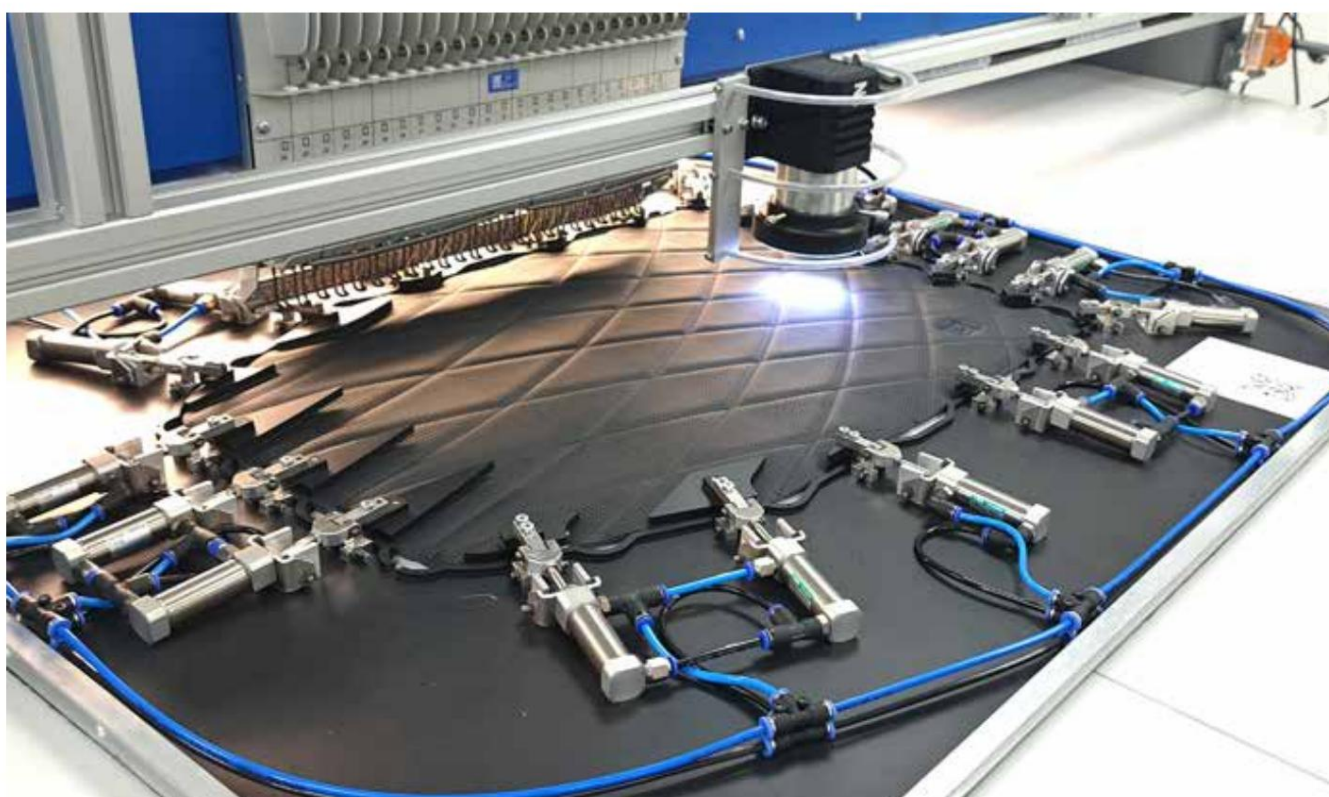
RACER 0124 s 24 jehlami a systémem ZSK Vision (optický polohovací systém - OPS 2). Rám: Rám na míru s pneumatickými svorkami a QR kódem pro automatizaci.
